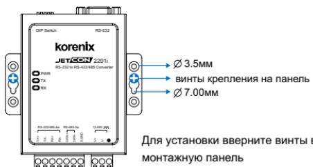
Для установки вверните винты в монтажную панель
